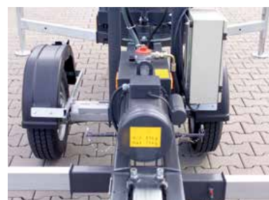
Essieu retractable, largeur de manœuvre de 0,89 m (en option)
