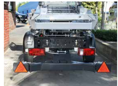
Eclairage intégré et protégé
