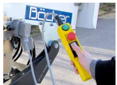
Commande électrique par la bas avec un câble de 4 m
