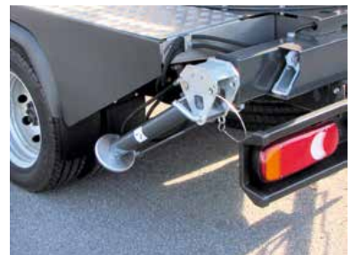
Poste de commande pour les stabilisateurs hydrauliques mécaniquement pivotement à 60°
