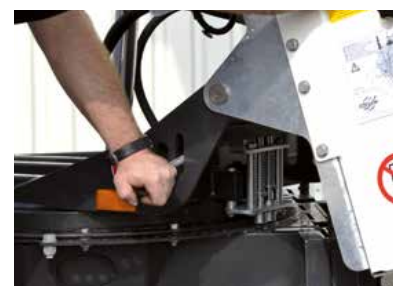
Couronne pivotante réglable, avec blocage à déblocage mécanique
