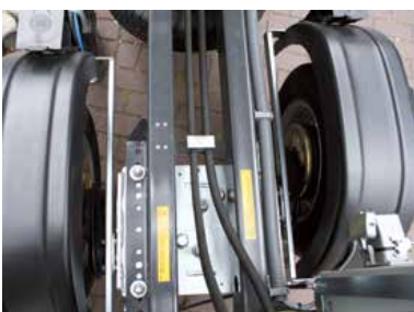
Un essieu retractable, largeur de manoeuvre 0,89 m (en option)
