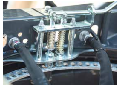
Blocage de couronne pivotante en continu, à déblocage mécanique
