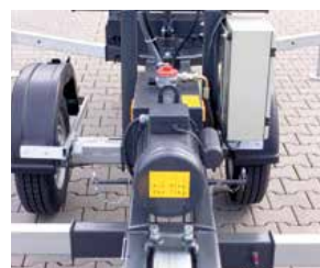
Essieu escamotable, largeur de manœuvre 0,89 m (en option)
