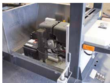
Moteur d'entraînement Honda économique et réservoir volumineux
