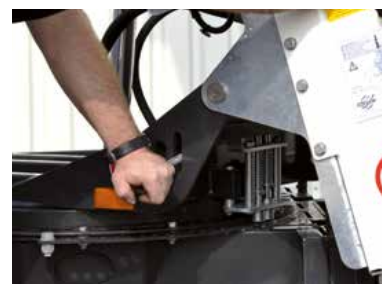
Tourelle réglable avec débloqué mécanique
