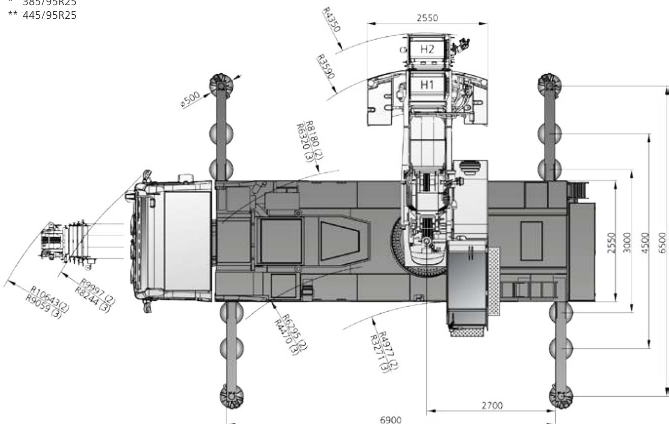
(2) steering mode 2 · Lenkfunktion 2 · mode de direction 2 · modalità di sterzata 2 · modo de conducción 2 · modo de manobra 2 · Режим поворота 2
